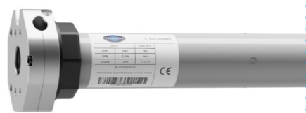
Napęd do oktagonalnej rury nawojowej Ø 60 z mechanizmem awaryjnego podnoszenia (napęd z adapterem i zabierakiem)
